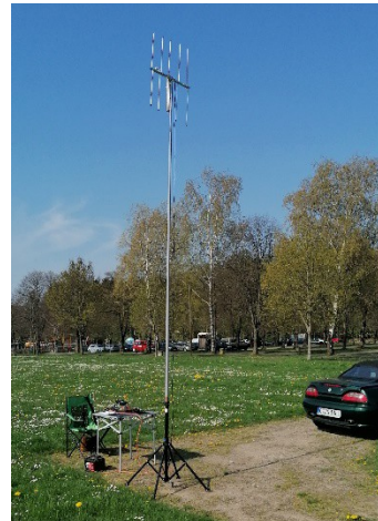
2m/70cm 5-Elemente Log-Periodic als Richt- antenne
