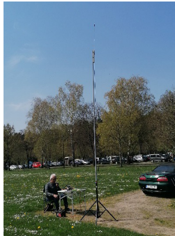
2m/70cm Mobilantenne als Rundstrahler
